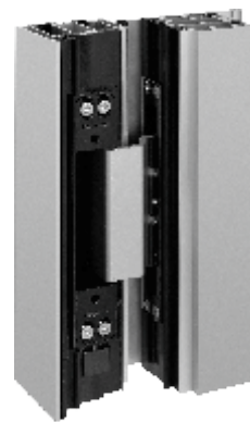
Verdeckt liegendes Türband, dreidimensional einstellbar, max. Öffnungswinkel 100°,
